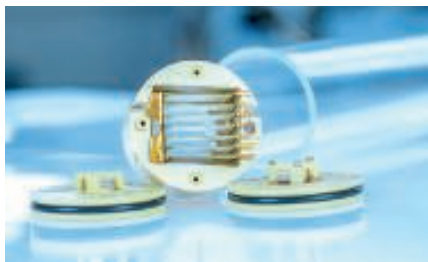
Wärmepumpen auf Basis elektrokalendarischer Materialien könnten in Zukunft eine bessere Lösung zum Heizen und Kühlen sein.
