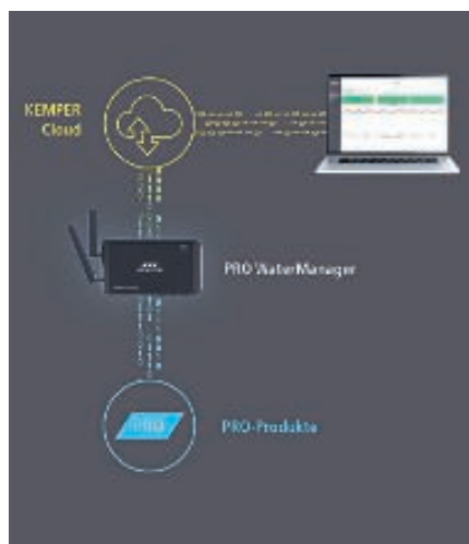
Als digitaler Knotenpunkt der Trinkwasserinstallation stellt der Pro WaterManager die Daten der Kemper Cloud zur Verfügung. Hier werden die Daten aufbereitet und visualisiert.
